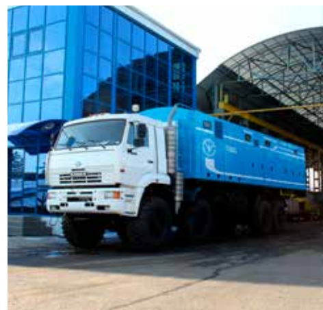
Азотная компрессорная станция ТГА на территории ООО «ККЗ»
