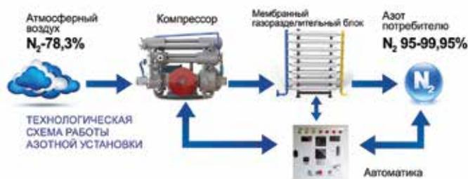
Рисунок 3 – Схема работы азотной установки ТГА
