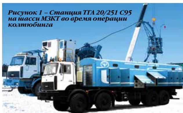
Рисунок 1 – Станция ТГА 20/251 С95 на шасси МЗКТ во время операции колтюбинга
